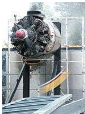
Fassadenaufbau während des Schlagregendichtigkeitstestes.
